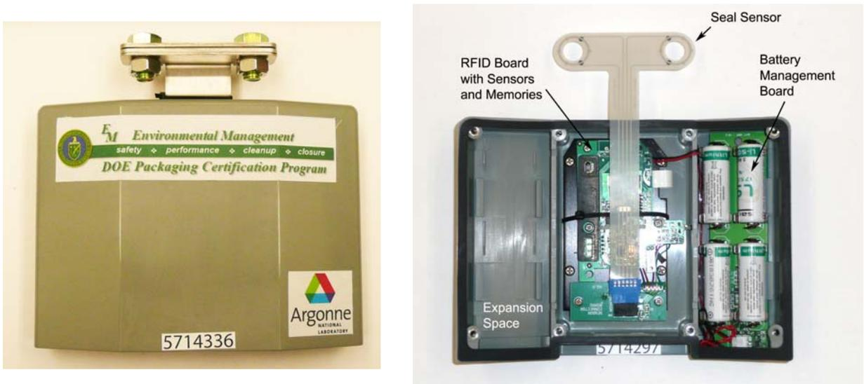
FIGURE 2. Mk-II RFID tag
